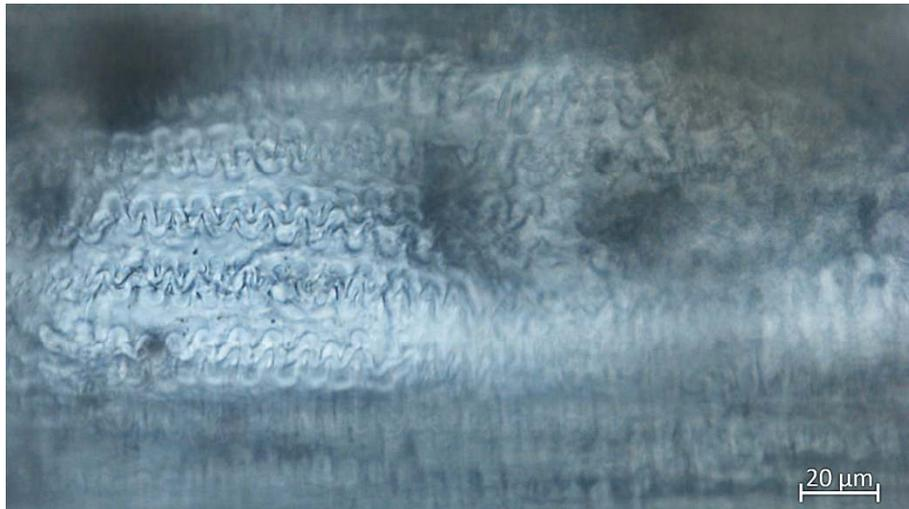
**Figura 3** – Sezione longitudinale del frammento vegetale presente nell’intonaco
